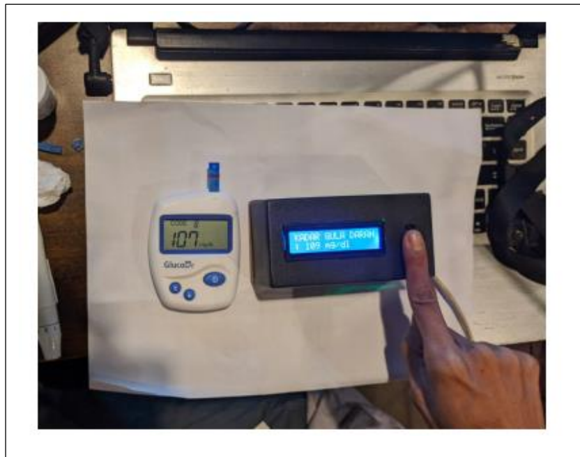
Gambar 6. Pengujian Alat Pendeteksi Kadar Gula darah pada Pasien
